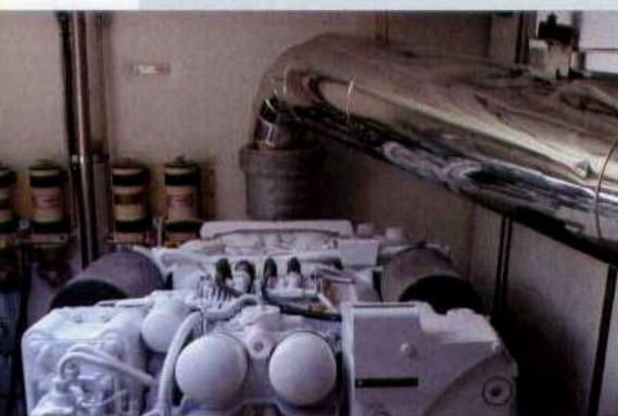
La sala macchine con due Mtu 8V-2000 M93 accreditati di 1200 cavalli.
